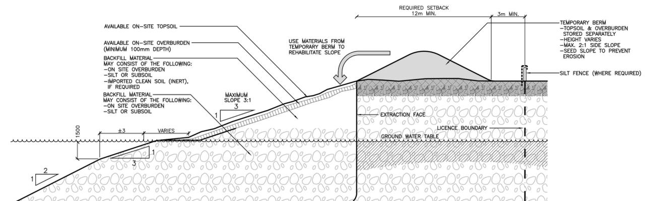
TYPICAL SIDESLOPE REHABILITATION BY BACKFILLING N.T.S.
